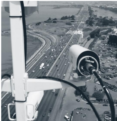
图 5.1 NGSIM 数据集采集设备以及场景
