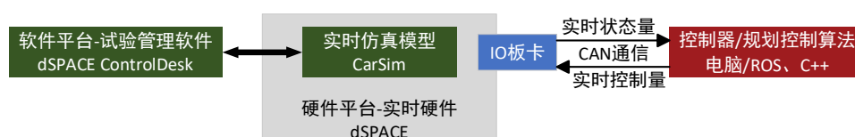
图 5.2 硬件在环仿真平台架构
